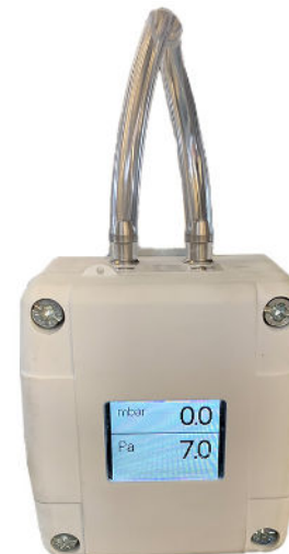
Überwachung Filterzustand (DDMU)
